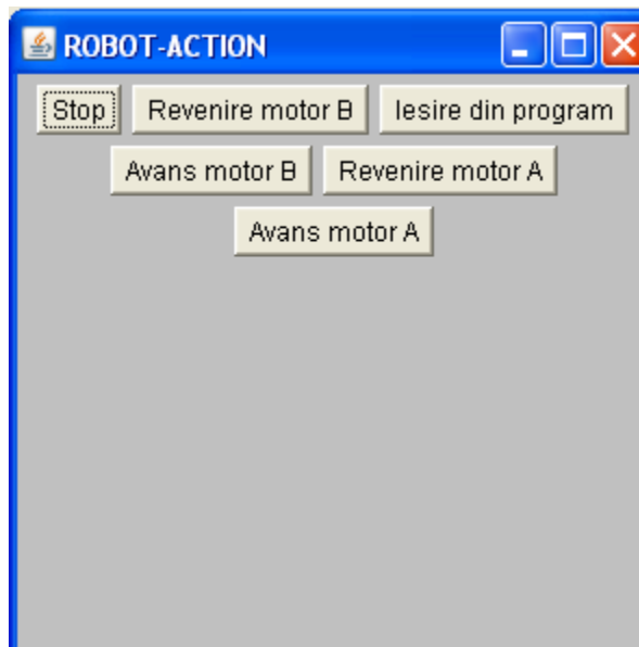
Fig 4.1 Interfata grafica ce permite manipularea robotului LEGO NXT, ce permite avansul si revenirea robotului pentru motorul A si motorul B.
